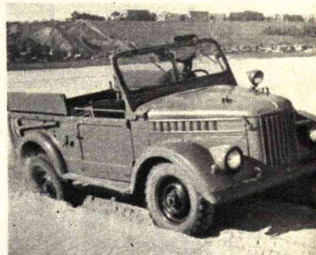
Если включить передний мост, все колеса станут ведущими и сыпучий песок быстро останется позади.
